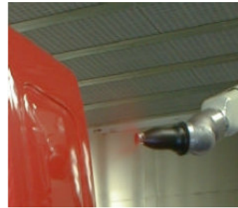
Figura 2: Aplicação de tinta por meio de pistola Fonte: DC (1)
